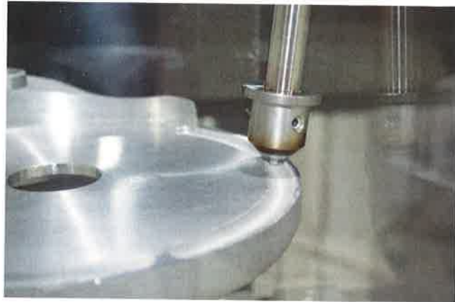
Zum Rührreibschweißen von Leichtbauwerkstoffen werden Hochleistungsschweißstifte genutzt. Bild: Hufschmied Zerspanungssysteme
